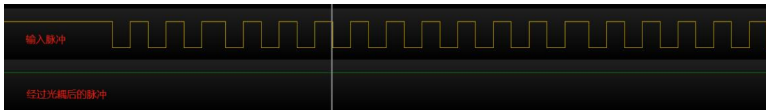
图 19.7 频率过高，限流电阻过大，0 个脉冲
